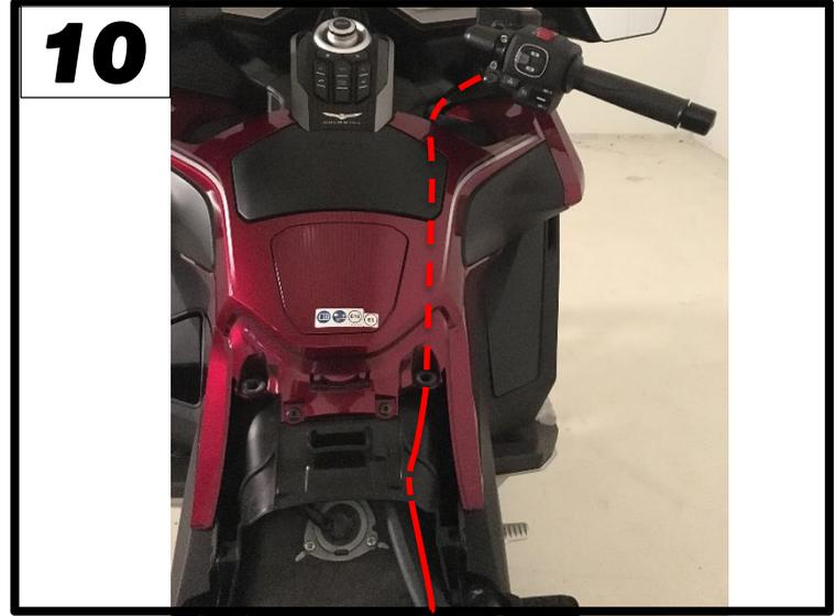
Verbinden Sie die Kabel der Stellmotoren und das des Tasters mit der REMUS Steuereinheit. Führen Sie den einpolig belegten Stecker auf die rechte und den dreipolig belegten Stecker auf die linke Fahrzeugseite zu den jeweiligen Steckanschlüssen. Diese finden Sie hinter den vorher abgenommenen Seitenverkleidungen. (Abb. 11 / 12).
