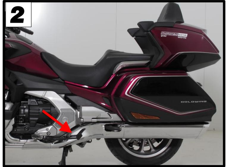
Entfernen Sie die Seitenabdeckungen und demontieren Sie die Sitzbank. Lösen Sie die Schellen und Halterschrauben der Schalldämpfer und nehmen Sie diese ab (Abb. 3 / 4).
